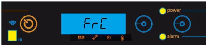
**Nota:** cuando el comando de infrarojos esta activo los LEDs de power y alarma parpadean de forma intermitente con el color verde.
